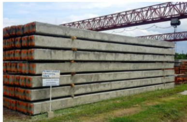
ฐานเสาไฟฟ้าคอนกรีตอัดแรง
